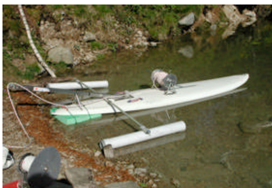
Gueuse à frein de F.Krieger montée sur un flotteur
